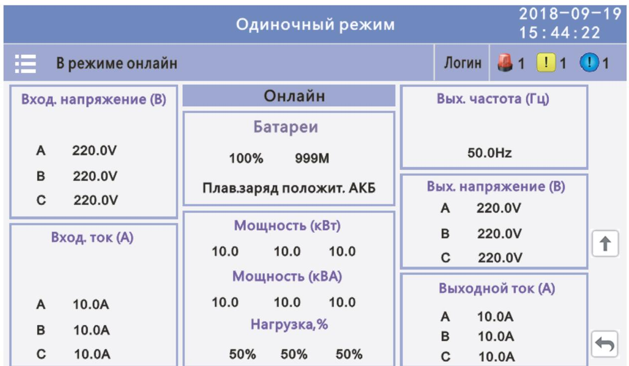
**4.3.2 Меню «Состояние».** Просмотр напряжения и тока сети, байпаса, выхода, АКБ (сюда также можно попасть через блок данных в реальном времени), просмотр состояния выключателей, сухих контактов и модуля, путем нажатия на блок перейдите к соответствующему окну с данными.
